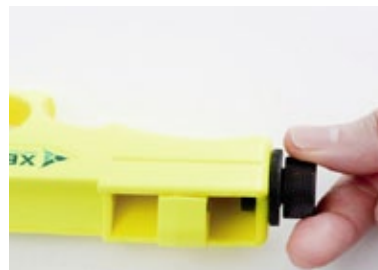
1. Arretierschraube lösen und Anschlag mit Hilfe der Justierschraube auf gewünschte Position (= gewünschter Faserüberstand) stellen.
