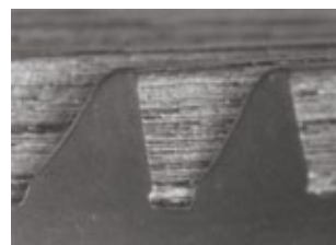
Entgraten eines Rings mit Verzahnung nach der Zerspanung. Werkstoff: CK45
