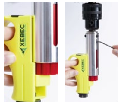
4. Sitzt die Faserbürste am Anschlag auf, kann die Arretierschraube der Faserbürste (siehe Schritt 3) wieder angezogen werden und die voreingestellte Länge des Faserüberstandes ist erreicht.
