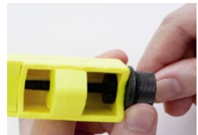
2. Arretierschraube feststellen um Anschlagposition zu fixieren.
