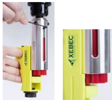
3. Werkzeughülse an Hülsenanschlag anlegen und Arretierschraube der Faserbürste lösen, bis sich die Faserbürste innerhalb der Werkzeughülse verschiebt.
